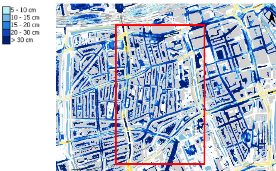
Χάρτης 24: Βάθος νερού σε περίπτωση έντονης βροχόπτωσης – σενάριο 140mm βροχής σε 2 ώρες
